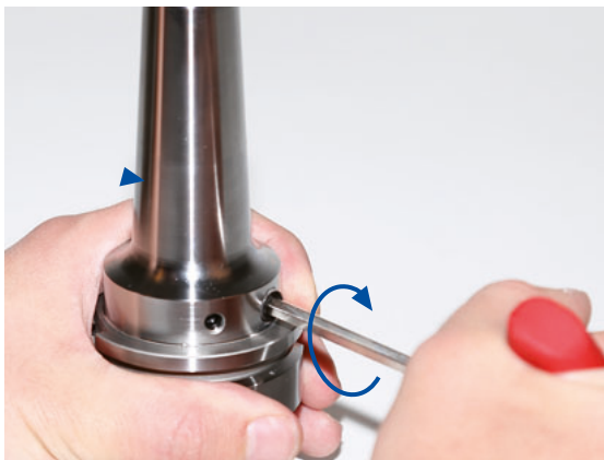
Abbildung 2: Spannschraube anziehen und Mindestumdrehungen beachten
