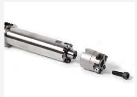
3. Das Werkzeug vom Fräseraufsteckdorn entnehmen.
