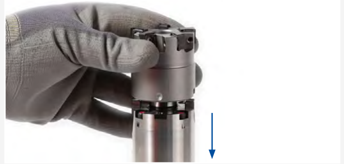
2. Den Fräseraufsteckdorn in eine Wechsellvorrichtung einspannen.
