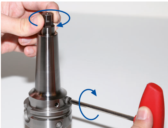
Abbildung 1: Spannschraube und Werkzeugprüfling drehen
