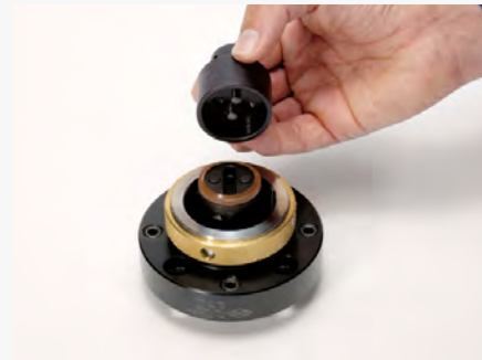
2. Steckschlüssel an der Spannpatrone ansetzen.
