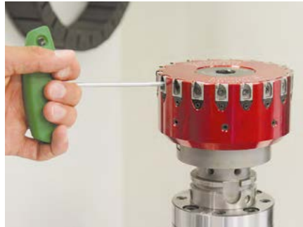
2. Desserrer l'insert de fraisage et le démonter par le haut du guidage en queue d'aronde.
