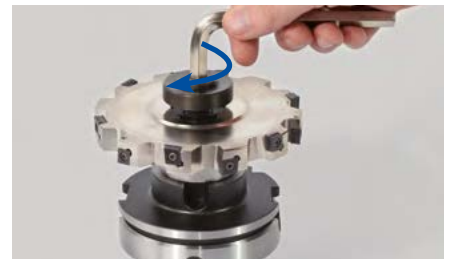
8. Continuer de serrer la vis de serrage avec une clé Allen dans le sens horaire puis avec une clé dynamométrique (couple de serrage, voir tableau « Couple de serrage pour vis de serrage »).
