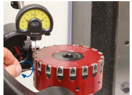
6. Placer le micromètre sur l'insert de fraisage réglé et remettre à zéro. Régler par micromètre les inserts de fraisage à 0,01 mm devant la cote EM. Dans ce contexte, tourner la broche filetée avec une clé Allen dans le sens horaire jusqu'à atteindre la cote zéro.
