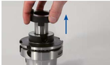
1. Démontez la bague d'entraînement de l'arbre porte-fraise.
