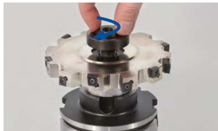
7. Tourner légèrement la vis de serrage sur l'arbre porte-fraise dans le sens horaire.
