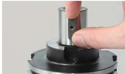
2. Monter la clavette sur l'arbre porte-fraise.
