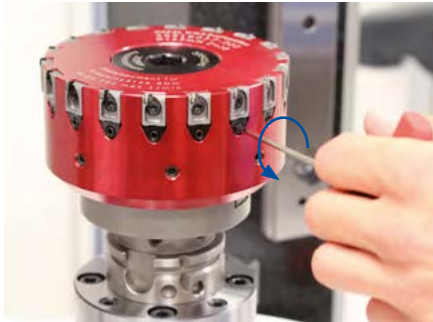
1. Tourner d'un tour dans le sens antihoraire la broche filetée avec une clé Allen (ouverture 2,5).
