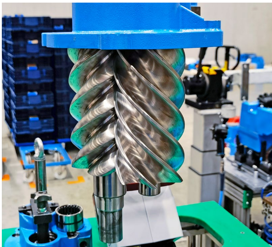
Teilmontierte Schraubenverdichter-Baugruppe, bestehend aus zwei Rotoren und dem blau lackierten Lagerdeckel.
