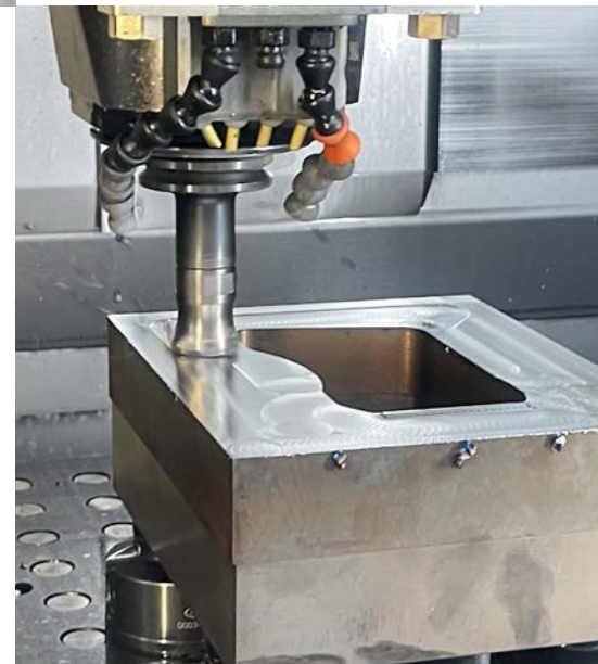
Leistet gleich beim Schruppen gute Vorarbeit: Der 35-mm-Hochvorschubfräser NeoMill-4-HiFeed-90.
