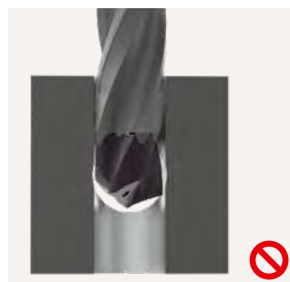
Bohrung mittig und \approx D
