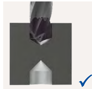
Durchbruch bei Gegenbohrung; v_f = -50\%
