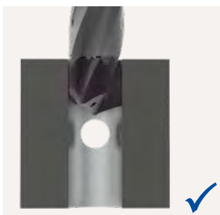
Bohrung mittig und \ll D
