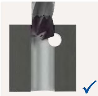
Bohrung außermittig; Querschnitte im Eingriff
