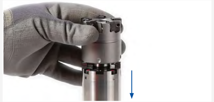
2. Frez nasadowy narzędzia należy umieścić w urządzeniu wymiennym.
