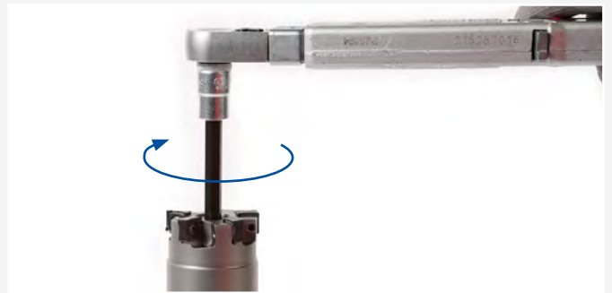
5. Ustawić klucz dynamometryczny na moment dokręcenia wymagany przez producenta frezów.
