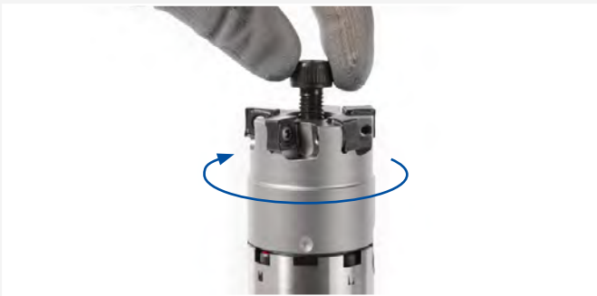
4. Ręcznie lekko wkręcić śrubę mocującą frez w gwintowany otwór w trzpieniu frezu.
