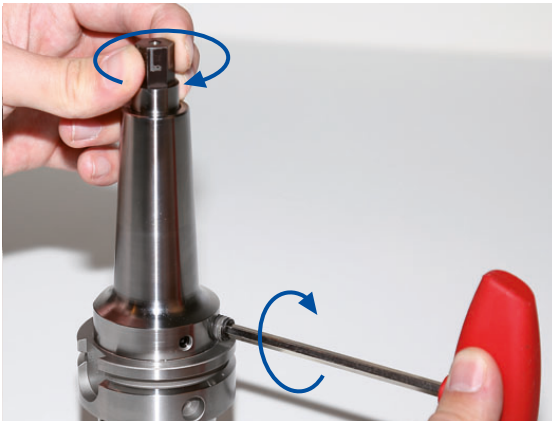
Rysunek 1: Śruba mocująca i obracanie narzędzia próbnego
