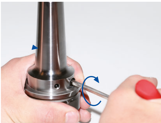
Rysunek 2: Dokręcenie śruby mocującej z uwzględnieniem minimalnej liczby obrotów
