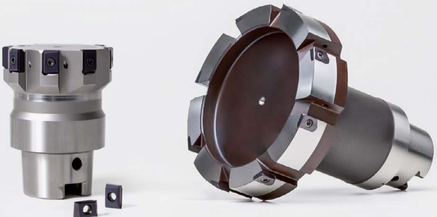
Prädestiniert für nachhaltiges Reiben mittlerer und großer Durchmesser: Die HPR400 plus Reibahlen (links) mit drehsymmetrischen Schneidplatten und je vier Schneidkanten und die HPR400 Reibahlen (rechts) mit prismatischen Anlagen für bestes Zentrieren.
