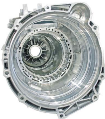
Bild 1: Blick ins Innere des Getriebegehäuses für ein Hybridfahrzeug mit zahlreichen coaxialen Übergängen, Passungen und definierten Fasen.
