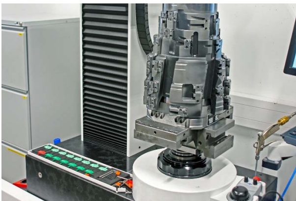
Bild 5: Das von MAPAL gelieferte Feinbohr-Stufenwerkzeug mit 20 Stufen ist mit 58 PKD-Schneiden sowie 22 PKD-Führungsleisten bestückt.
