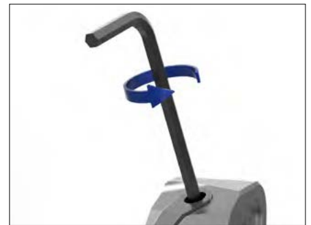
3. Gewindespindel 1,5 Umdrehungen gegen den Uhrzeigersinn drehen.
