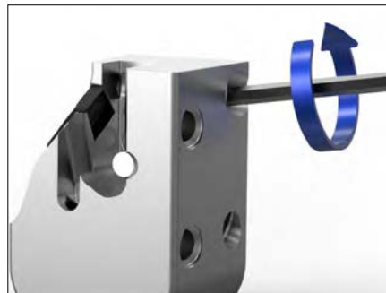
2. Die Wendeplatte auf Grundeinstellung zurücksetzen: Justierschraube mit einer halben Umdrehung gegen den Uhrzeigersinn zurückdrehen.
