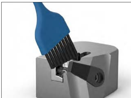
4. TEC-Wendeplatte entnehmen. Wendeplattensitz und TEC-Wendeplatte säubern.
