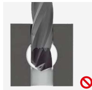
Bohrung mittig und \gg D
