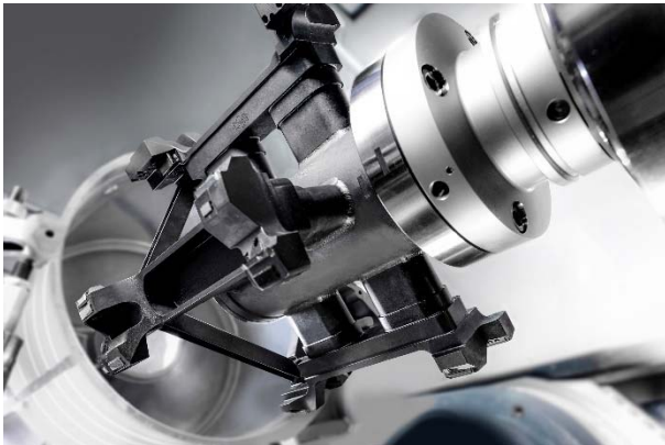
Bild 1: Um die Hauptbohrung des Statorgehäuses \mu m-genau zu fertigen, wird sie mit einem Feinbohrwerkzeug von MAPAL bearbeitet. (Bild: HELLER)
