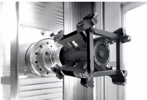
Bild 4: Das Werkzeugkonzept überzeugt unter anderem durch sein niedriges Gewicht sowie die feinjustierbaren PKD-Schneiden
