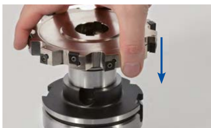
5. Umieścić narzędzie czołowo na trzpieniu frezarskim nasadzonym.
