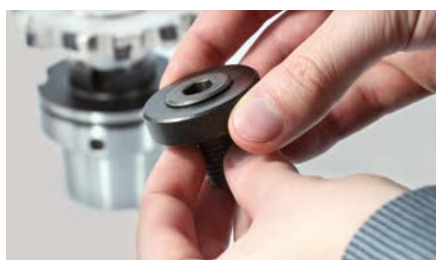
6. Obracać śrubę gwintowaną tak długo, aż będzie wystawać na 1-2 mm z pierścienia gwintowanego.
