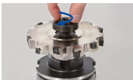
7. Lekko nakręcić śrubę do mocowania frezu na trzpień frezarski nasadzany w kierunku zgodnym z ruchem wskazówek zegara.
