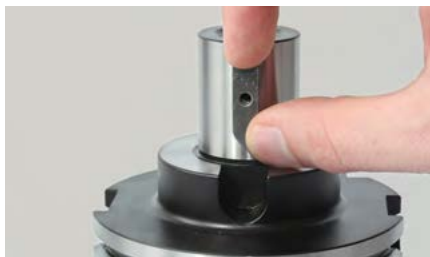
2. Włożyć wpust piórowy na trzpień frezarski nasadzany.
