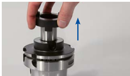
1. Zdjąć pierścień prowadzący z trzpienia frezarskiego nasadzanego.
