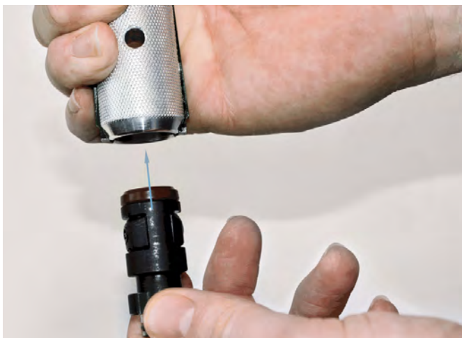
Inserimento della cartuccia di serraggio KS nella pinza di montaggio KS
