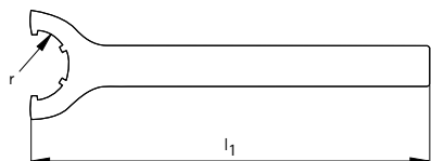
Chiave di serraggio per mandrini di serraggio per pinze secondo DIN 69882-6 e mandrini per maschiatura Softsynchro
