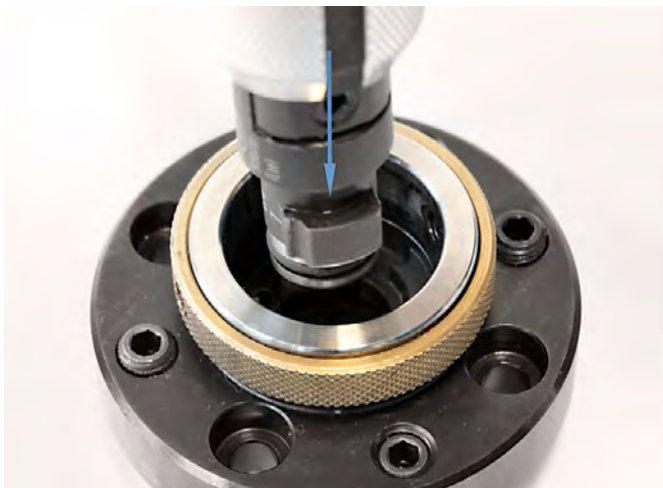
Inserimento della cartuccia di serraggio KS
