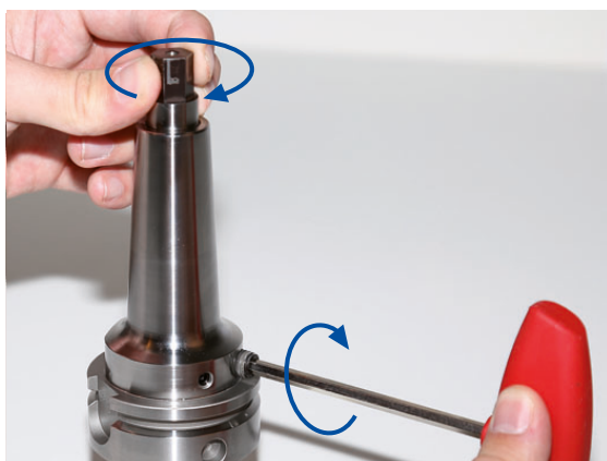
Figura 1: Ruotare la vite di serraggio e l'utensile di prova
