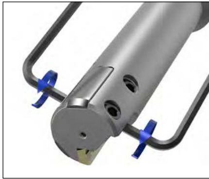
2. Cómo soltar la plaquita de sujeción Girar el tornillo diferencial 2-3 vueltas en sentido antihorario desde ambos lados (el inserto reversible apunta hacia abajo).
