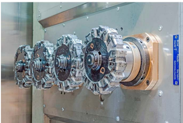
Bild 4: Vierfach-Einsatz von Scheibenfräsern für Querlenker. Die massiven Schnittstellen sind ein Hinweis auf die hohen erforderlichen Antriebsleistungen (Foto: ELHA).
