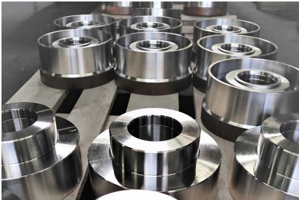
Bild 3: Alle gängigen Werkstücke werden mit modernsten CNC-Maschinen gedreht, gefräst und geschliffen.
