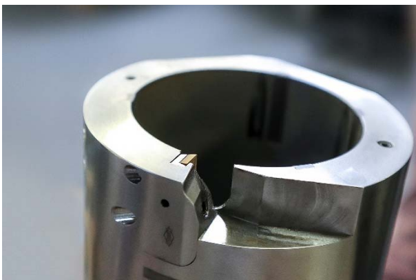
Bild 4: Mit der Außenreibahle wird prozesssicher eine Zylinderformabweichung von weniger als 5 \mu\text{m} erreicht.
