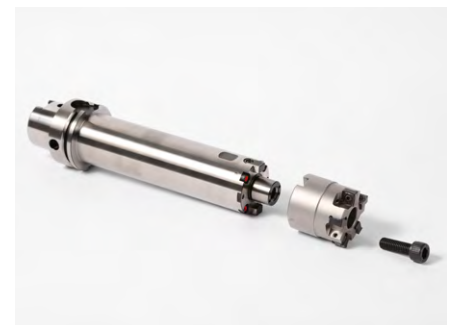
3. Das Werkzeug vom Fräseraufsteckdorn entnehmen.
