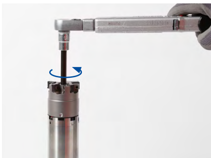
1. Die Fräseranzugsschraube zum Beispiel mit Hilfe des Drehmomentschlüssels lösen.
