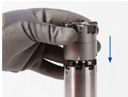
2. Den Fräseraufsteckdorn in eine Wechsellvorrichtung einspannen.
