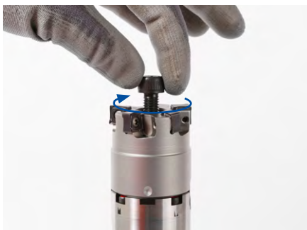
4. Die Fräseranzugsschraube in die Gewindebohrung des Fräseraufsteckdorns von Hand leicht eindrehen.
