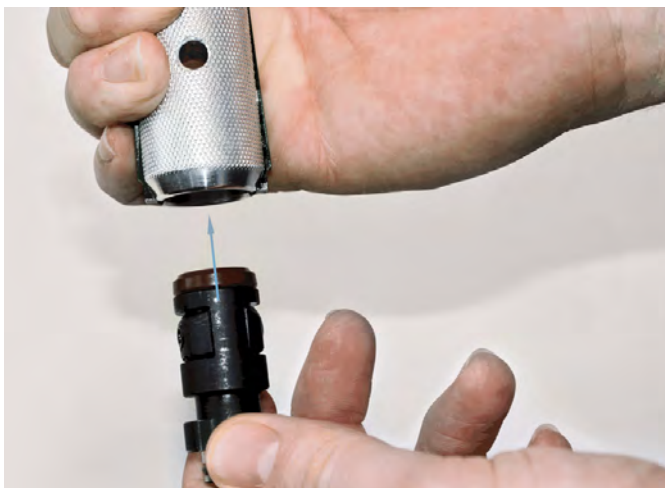
Colocación del cartucho de sujeción KS en la pinza de montaje KS
