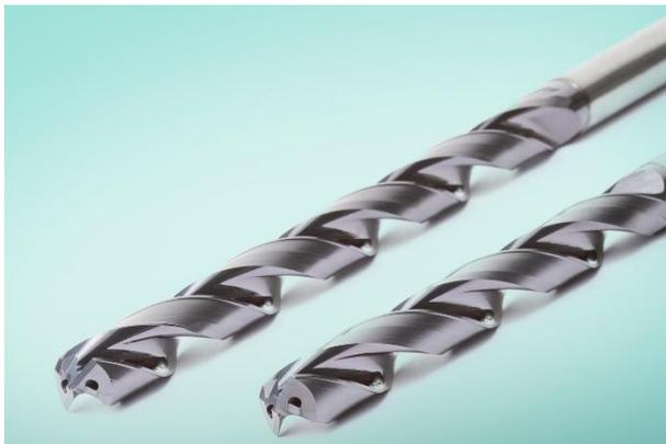
Mit 8xD und 12xD in Edelstahl: Erzwungene Orbitalbewegungen verringern den Druck auf die drei Führungsfasen des MEGA-Speed-Drill-Inox. Der Nutkern verjüngt sich nach hinten und sorgt für zuverlässige Spanabfuhr. ©MAPAL
