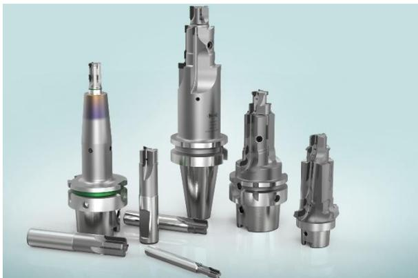
Die Bandbreite an Lösungen für das PKD-Gewindefräsen ist groß: Von tiefen Gewinden mit langen Schneidkanten und unterschiedlicher Zähnezahl über stabile Kombinationswerkzeuge und Gewindefräser mit individuellem Kühlkonzept mit Minimalmengenschmierung bis zur einfachen, kostengünstigen Werkzeuglösung.
