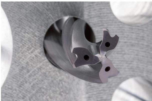
Bohren und Reiben in einem: Mit einer selbstzentrierenden Querschneide und sechs Führungsfasen bietet der dreischneidige Tritan-Drill-Reamer höchste Prozesssicherheit bei unterschiedlichsten Einsatzparametern. © MAPAL
