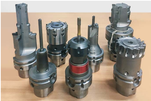
Bild 4: CastAlum setzt vor allem PKD-Werkzeuge von MAPAL zum Bohren und Fräsen ein.
