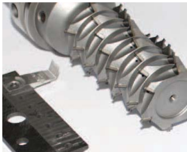
PKD-Sonderfräser bearbeitet acht Nuten mit nur 1 mm Breite in einem Arbeitsgang.
