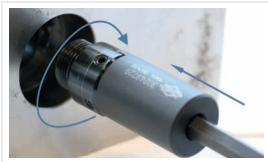
Abbildung 9: Sockel mit Montagehilfsmittel fest-schrauben
