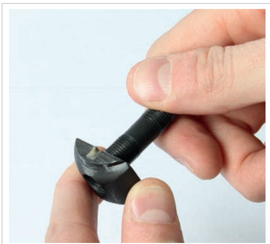
Abbildung 4: Eindrehen der Gewindespindel in die kleinere Spannbacke
