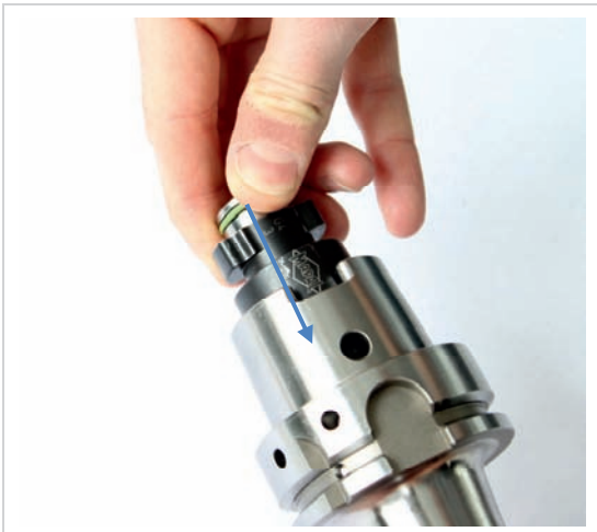
Abbildung 7: KS-Spannpatrone mit Werkzeug testen
