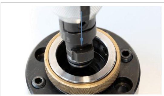
Abbildung 6: Einsetzen der KS-Spannpatrone
