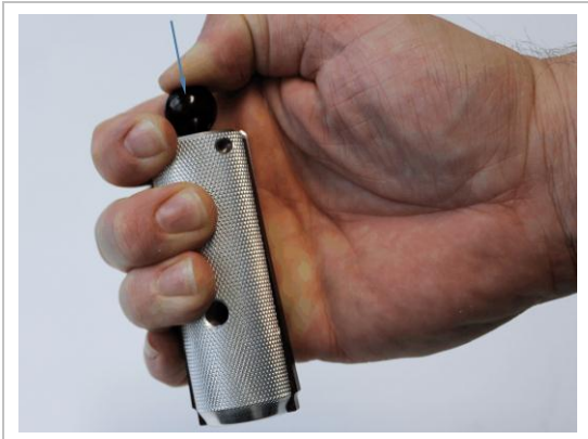
Abbildung 4: Öffnen der KS-Montagezange
