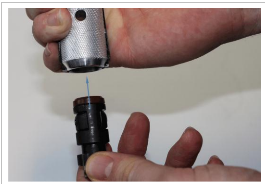
Abbildung 5: Einsetzen der KS-Spannpatrone in die KS-Montagezange
