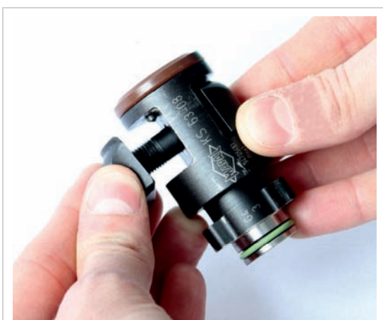
Abbildung 5: Eindrehen der Gewindespindel in die größere Spannbacke
