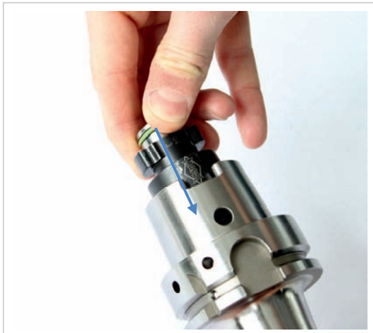
Abbildung 7: KS-Spannpatrone mit Werkzeug testen
