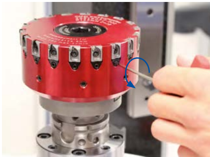
1. Con una chiave a brugola di misura 2,5 ruotare il grano a doppio effetto di un giro in senso antiorario.
