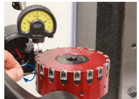
6. Posizionare l'indicatore a quadrante sulla cartuccia di fresatura regolata e portarla sullo zero. Regolare la cartuccia di fresatura mediante l'indicatore a quadrante su 0,01 mm prima del valore EM. A tale scopo ruotare il grano a doppio effetto in senso orario, tramite la chiave a brugola, fino a raggiungere la misura zero.
