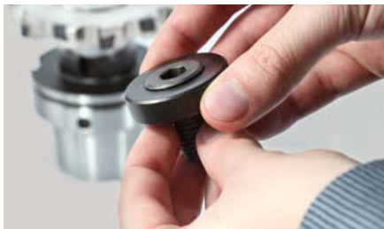
6. Ruotare il perno filettato fino a raggiungere una sporgenza rispetto all'anello filettato pari a 1-2 mm.
