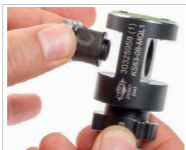
Abb. 24: Einsetzen der Spannbacke (3)
