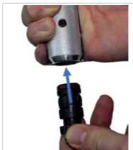
Abb. 7: Einsetzen der KS-Spannpatrone in die KS-Montagezange
