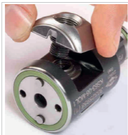
Abb. 25: Einsetzen der Gewindespindel
