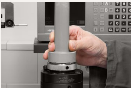
3. Kegel und Planfläche von Prüfdorn beziehungsweise Werkzeug reinigen.
