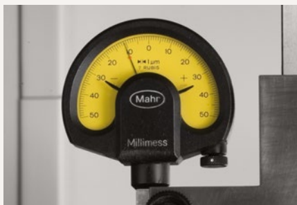
6. Vorsatzflansch grob ausrichten (ca. 0,01 mm). Justierschrauben nach jeder Betätigung wieder entspannen.
