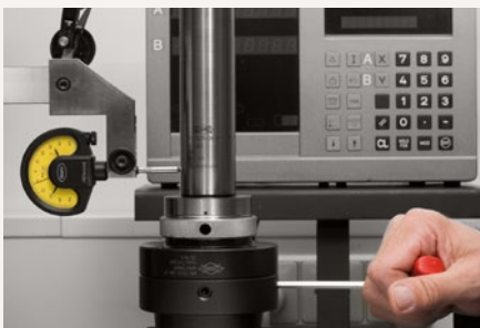
6. Vorsatzflansch grob ausrichten (ca. 0,01 mm). Justierschrauben nach jeder Betätigung wieder entspannen.
