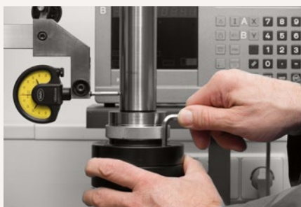
8. Befestigungsschrauben über Kreuz anziehen und auf Anzugsmoment bringen (siehe Tabelle). Nach dem Erreichen des vollen Anzugsmoments Radialausrichtung nochmals kontrollieren und gegebenenfalls korrigieren. Justierschrauben leicht anlegen.
