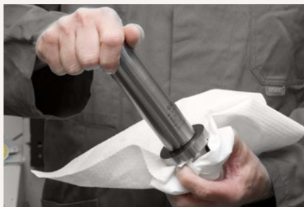
2. Vorsatzflansch einfügen. Befestigungsschrauben mit 50 % des vorgegebenen Anzugsmoments anziehen (siehe Tabelle).
