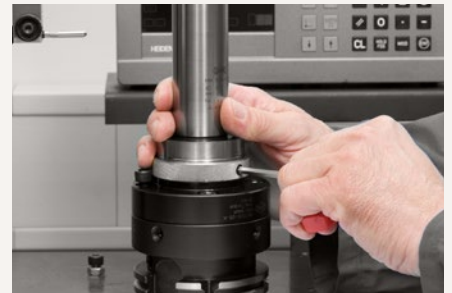
4. Prüfdorn beziehungsweise Werkzeug einsetzen und mittels Spannschraube befestigen.
