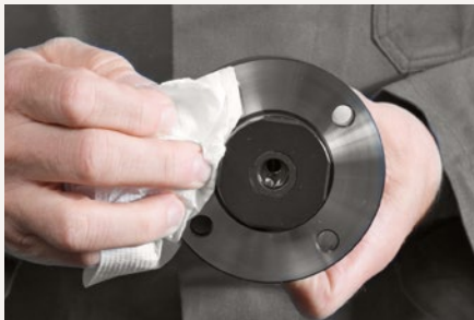
1. Kegel und Planflächen von Vorsatzflansch und Adapter reinigen.
