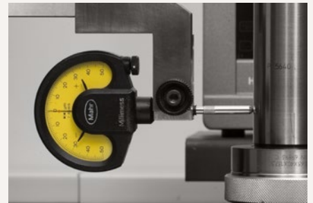
5. Messuhr an der Rundlaufkontrollstelle in Position bringen. Bei MAPAL Werkzeugen kann auch am HSK-Bund ausgerichtet werden. Höchsten Messpunkt aufnehmen und Messuhr auf „null“ bringen.
