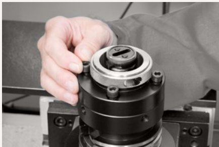
2. Vorsatzflansch einfügen. Befestigungsschrauben mit 50 % des vorgegebenen Anzugsmoments anziehen (siehe Tabelle).
