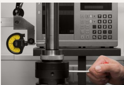
7. Rundlauf mit Justierschrauben einstellen. Auch dabei die Justierschrauben nach jeder Betätigung wieder entspannen. Vorgang so oft wiederholen, bis der Rundlauffehler < 3 µm beträgt.
