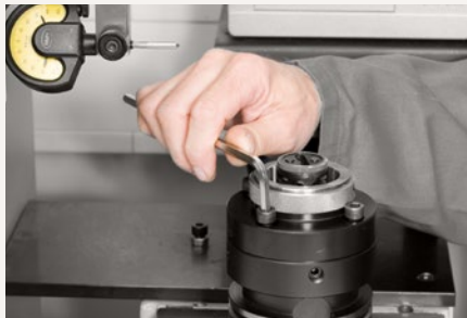
2. Vorsatzflansch einfügen. Befestigungsschrauben mit 50 % des vorgegebenen Anzugsmoments anziehen (siehe Tabelle).
