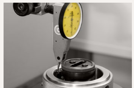
Die Radialausrichtung kann auch mit Mess-tastern vorgenommen werden. Hierzu wird der Taster an dem Kegel des Vorsatzflansches angelegt.
