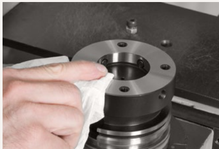
1. Kegel und Planflächen von Vorsatzflansch und Adapter reinigen.
